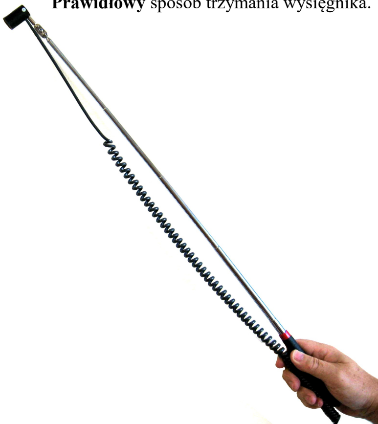
Prawidłowy sposób trzymania wysięgnika.
